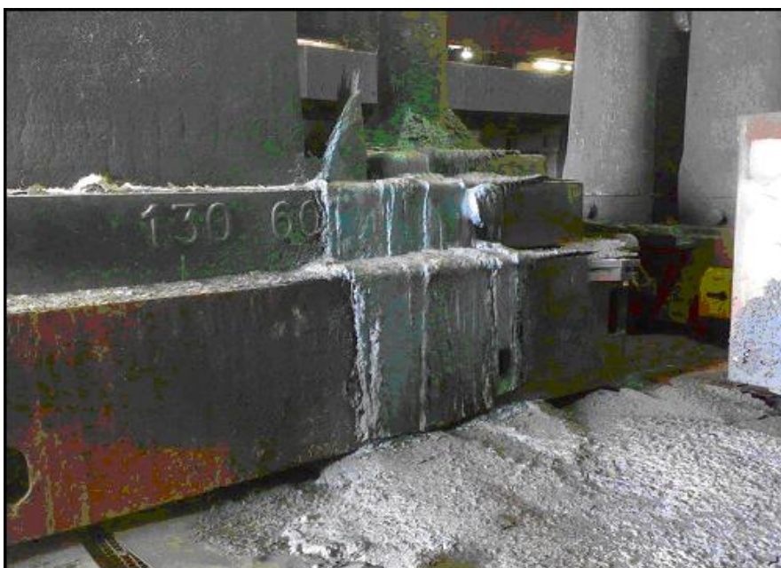
Abb. 13 Ausgelaufener Stahl nach Kokillenbruch während des seismischen Ereignisses vom 23.02.2008.
